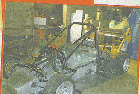
Sotto a sinistra: Leonardo Elia, imprenditore e costruttore dell'omonima barchetta; sotto, il telaio tubolare della Avrio; in alto, "Mimmo" Polizzi in azione a Gubbio (Foto BIONDO e CRONOSPRINT)
